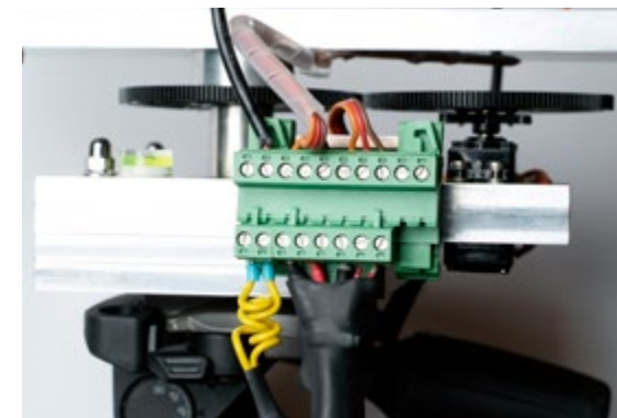
Reihenklemme zum Anschluss der Kabelpeitsche Links das Auslösekabel, rechts daneben Stromversorgung und Steuerung der Servomotoren
