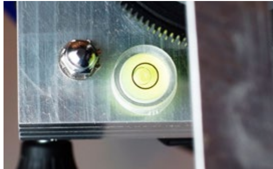
Auf die Grundplatte aufgeklebte Libelle zur Ausrichtung.
